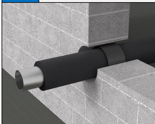
Rys.3 Rury niepalne w izolacji ciągłej przechodzące przez ścianę sztywną A \geq 150 mm
