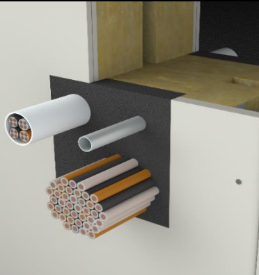
Rys.5 Uszczelnienie przejść elektrycznych / mieszanych w ścianie podatnej / sztywnej A \geq 100 mm
